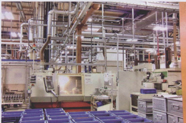
图6 冷却泵的转速调节保证了整个冷却润滑网络的压力恒定
