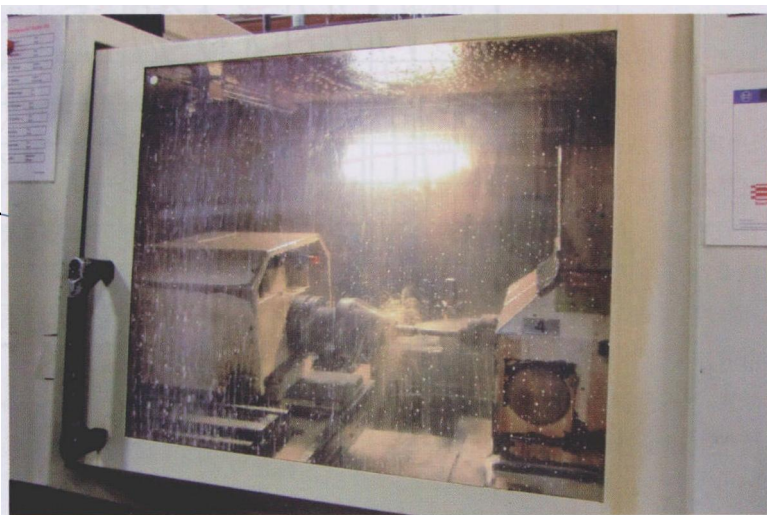
图2 自动化的磨削机床对冷却液压力的稳定性提出了很高的要求。冷却液应在恒定压力状态下喷射到砂轮与工件之间
