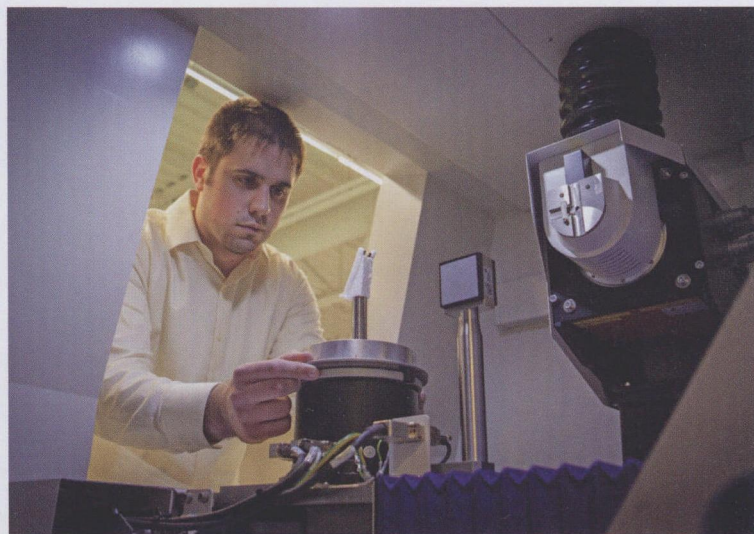
图 1 将夹紧的零件装卡到测量机上进行扫描，右上角所示为 X 射线发射器，该发射器与零件之间是固定式校准仪
