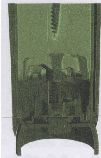
图 2 CT 扫描就像戴上一副 X 射线眼镜，可以让我们直接透视一个组装件，清楚地看到各个零件相互匹配的情况
