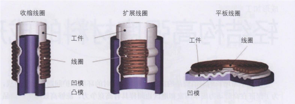
图 2 管材收缩、膨胀和板材成形使用的典型线圈
