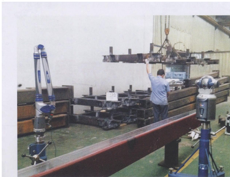
图1 安装在同向兴业车间内的便携式 FARO Laser Tracker ION 及 FaroArm
