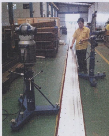
图 2 Laser Tracker 的测量范围广泛，Arm 则能有效地处理物体的细节
