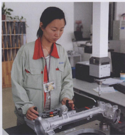
图3 品管部主任郭晓燕女士正在检测的这款汽车转向器零件，需要检测100多个相关的形位尺寸，用蔡司三坐标测量机最快只需25 min即可完工
