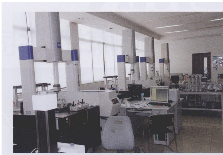
图2 雄邦压铸检测室，整齐排列的这四台蔡司三坐标测量机主要检测尺寸相对较小的零件
