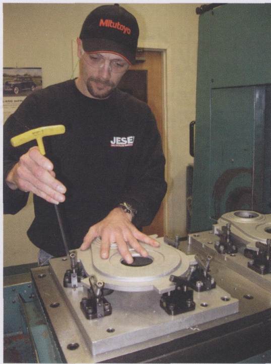
图 6 这种夹具采用了一种执行器机构，这种机构能够从表面形状的下面升起一个棒杆进行检测，然后再从上方将其固定
