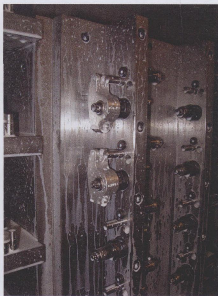
图5 均衡器式夹具能够自行找到并夹紧那些位置上可能有变化的表面形状，诸如这些铸造部件上的凸片
