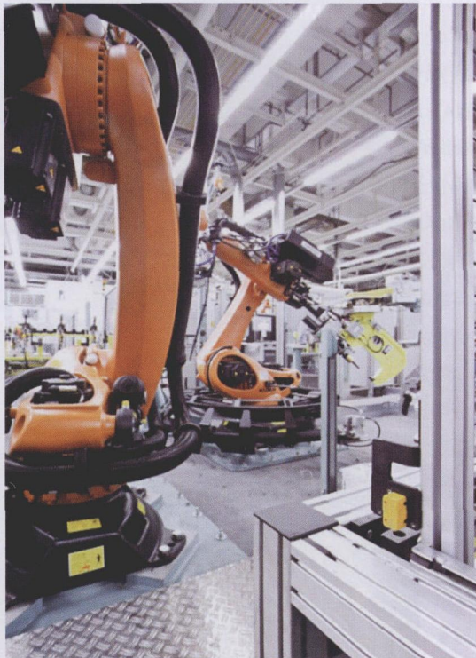
图 1 此试验车间多处用到皮尔磁的安全开关 PSEncode, 比如对牵出机、翼板、旋转台和摆动挡板等提供无触点监控
