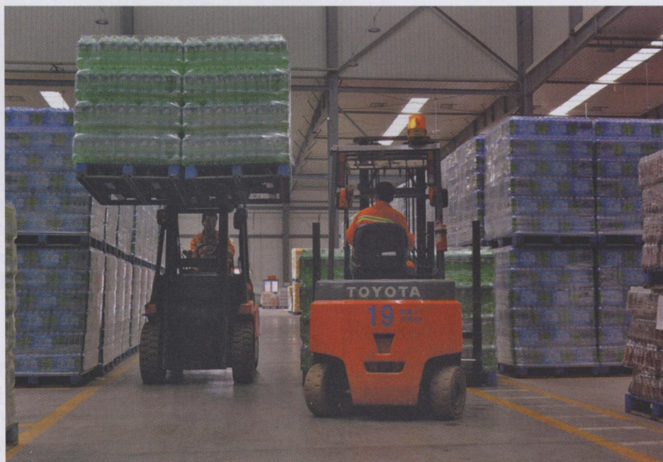
图 1 漯河太古可口可乐采用装有双叉的丰田平衡重叉车，在节省人工成本的同时大大提升了作业效率
