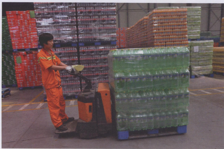
图2 丰田叉车 BT 品牌的5 辆托盘搬运车 LPE200 负责混合托盘的搬运
