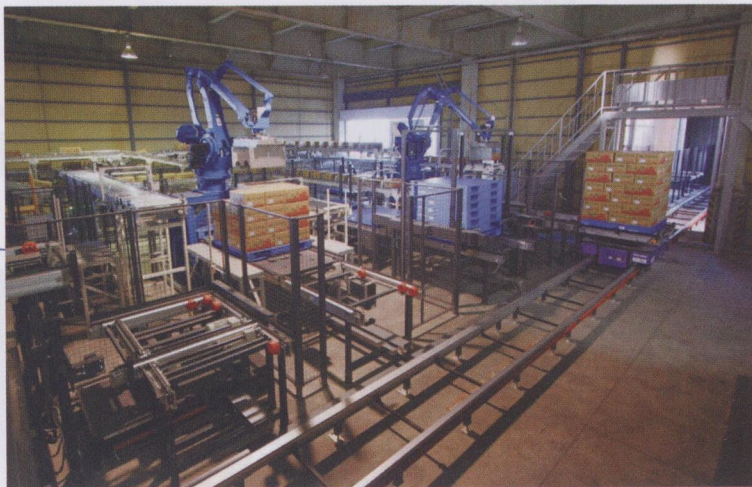
图 2 码垛机器人堆好货物后, 再次入单元拣选式自动仓库进行冷藏
