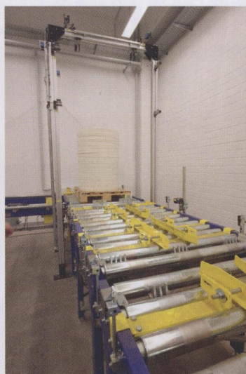
图5 借助监控器和称重装置来检测各种不同高度的托盘的轮廓和重量。如果托盘的外形轮廓和重量超出规定值, 立刻会被检测出来。这样避免了将不合乎要求的托盘或错误的货物存入仓库, 从而确保物流生产流程的最佳化
