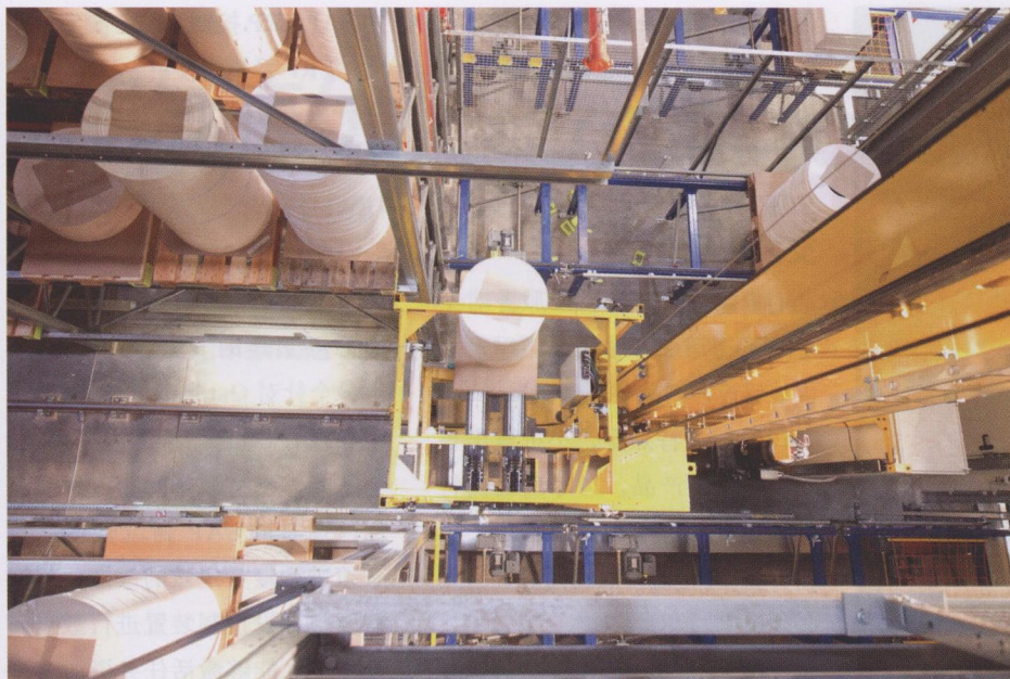
图4 Ostermann 公司配送中心的高货架仓库 (HRL) 货物入库或出库均采用托盘运输方式, 在物流生产流程中, 货架操作机 (RBG) 起着升降机的作用
