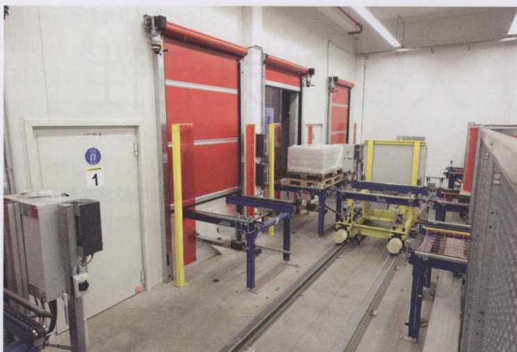
图7 在 Ostermann 有限公司配送中心的仓库里, 由货物推送车均衡地将货物分配到两个通道上
