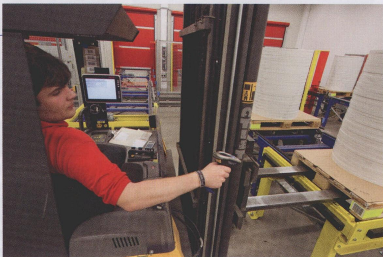
图 3 Ostermann 配送中心的高货架仓库（HRL）使用进料推进装置进行物流运作。一旦托盘出现在出货台上，叉车驾驶员便进行扫描，通过监视器能得到目标库房位置
