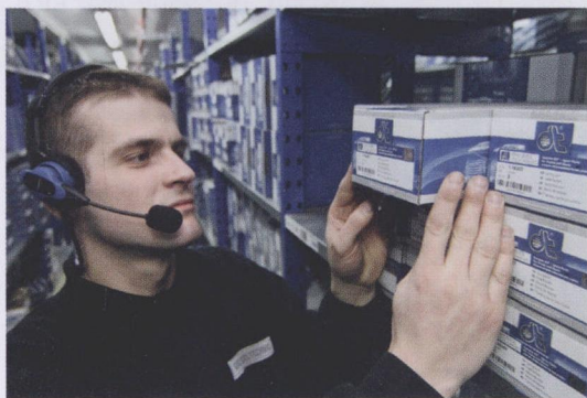
图3 采用语音拣选技术，增加了 Diesel Technic 股份公司的小五金仓库里拣选人员的活动自由度
