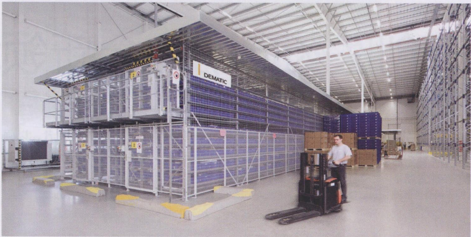
图 2 多层穿梭车系统可存储 8000 多个货箱，空间利用率高
