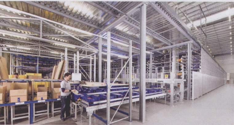
图 3 多层穿梭车系统每小时输送 800 多个料箱到订单拣选站
