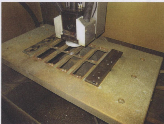
图 3 安装在该车 间 EDM 机床 上的一套带 定位销的 专用夹具， 可以让离合 器杠杆板 快速夹紧 就位
