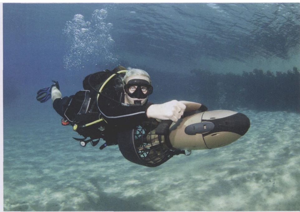
图2 这个水下推进器是同时具有优异性能和完美外形的典型代表，流过该推进器马达外罩的流体，以及流经推进器的流体都要求进行流体动力学分析以及轮廓检验，以确保优异的水下运动性能，舒适且符合人机工学原理的把手和低平的转舵结构能够减少其在水中的阻力
