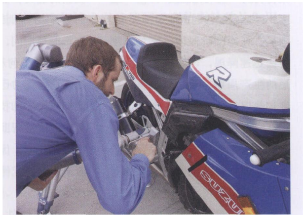
图1 为了实现最优化的性能，对这辆摩托车的隔热层轮廓进行了多次试验，任何的偏差都将导致性能的下降，这对于在整个轮廓上达到极为紧密的配合公差具有关键性意义
