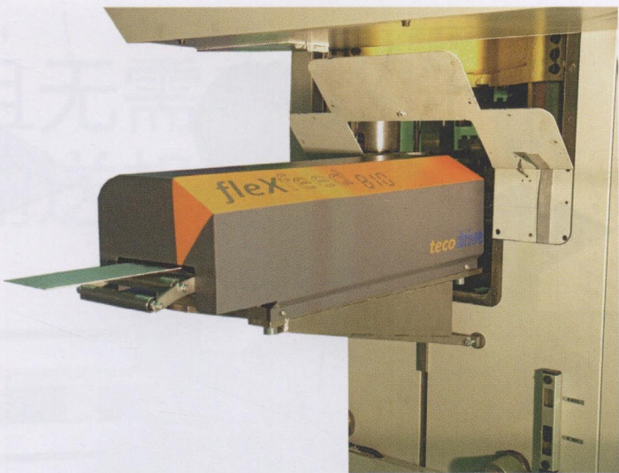
图 6 非接触式材料输送机 Flexfeed 安装在压力机中的情况
