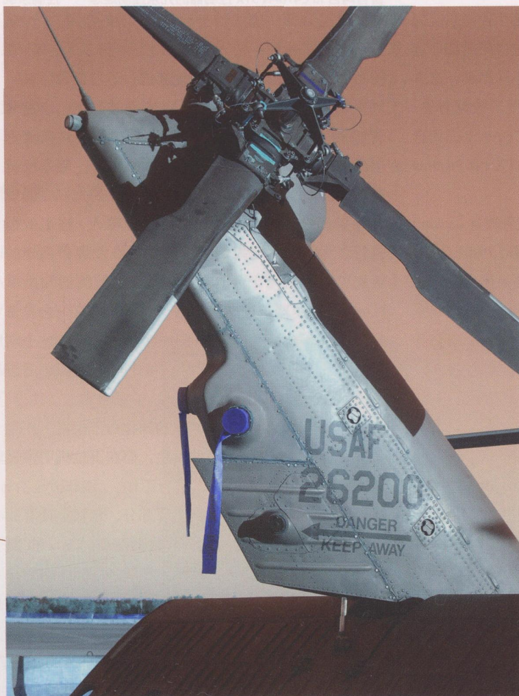
图1 这个尾翼转子的轮毂是一个 14 in 2 的钛金属组件，其平直度公差为 0.002 in
