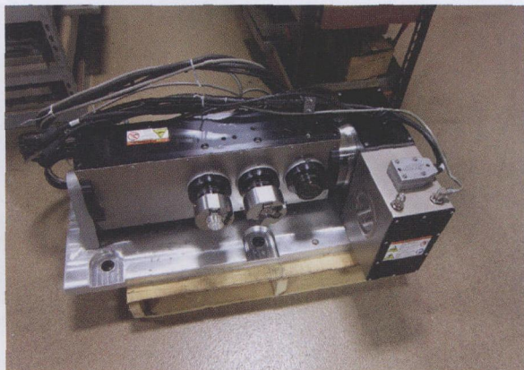
图4：这家加工厂的2台5c分度器让操作者可以在装夹多个部件的情况下实现长时间加工运行，而无需执行3轴加工所需的连续式装夹和卸装部件操作。
