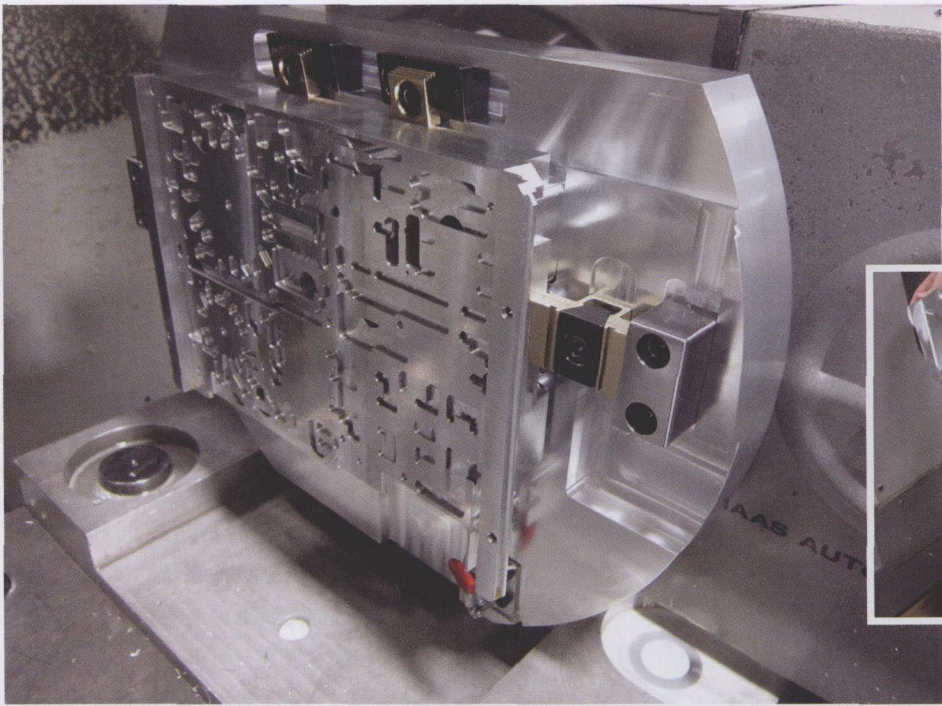
图 1：CNC Industries 为其 Haas VF 机床购买了 4 轴和 5 轴旋转工作台，淘汰了 3 轴作业的发展思路。
