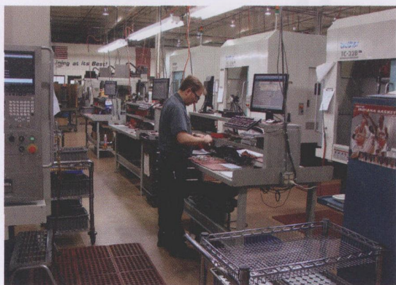
图 6：为每台 CNC 机床配备的计算站让操作者能够访问由这家加工厂自行开发、功能强大的企业资源规划（ERP）系统，获得自己工作所需要的所有信息。这套 ERP 系统所本质具备的灵活性让这家加工厂能够修改系统以满足不断变化的需求。
