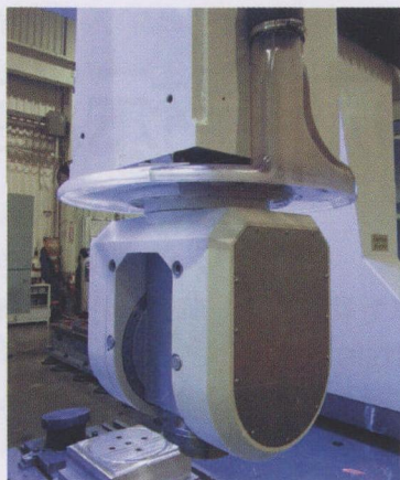
PMT 专有的真空隔罩和风道设计能够有效地控制复合材料粉尘污染。
