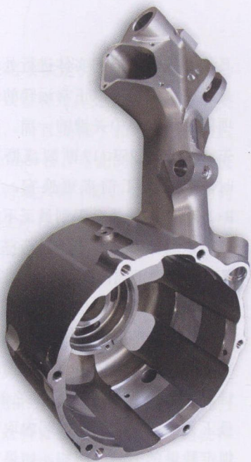
图 2:Applied Engineering 公司专业加工复杂航空部件。这些部件采用 6061 铝合金加工而成，加工批次量为 20 个，并要求公差为 \pm 0.0004\text{inch} 。
