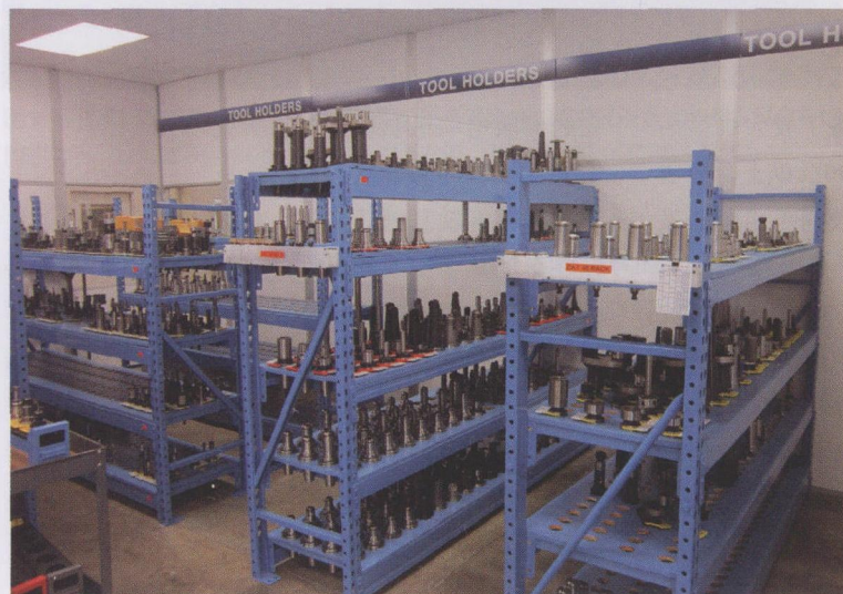
图 6：公司每 6 个月会将近期没有用到过的刀具架向后移动至库存的前面以便进行重新使用。除了显著地节约成本之外，这种重新认证和循环使用的体系对于流程标准化做出不小的贡献。
