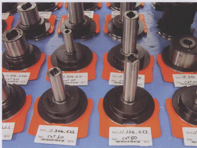
图 5：目前已经利用被动性 RFID 标签获取刀具架在整个加工工厂内的行踪。
