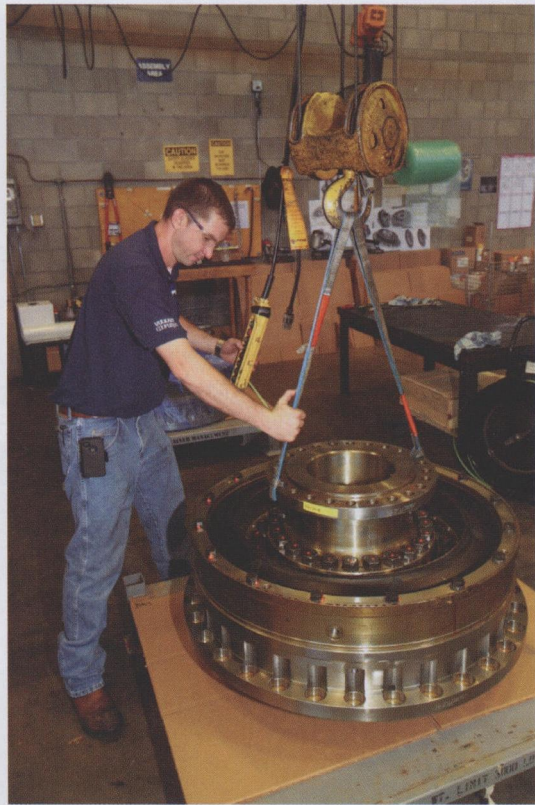
图 2 Vulkan 公司所制造的较小型的联轴器正在准备发货。内钢圈与外钢圈之间的黑色橡胶芯提供了实现稳定、牢固和安全传动所需要的挠性
