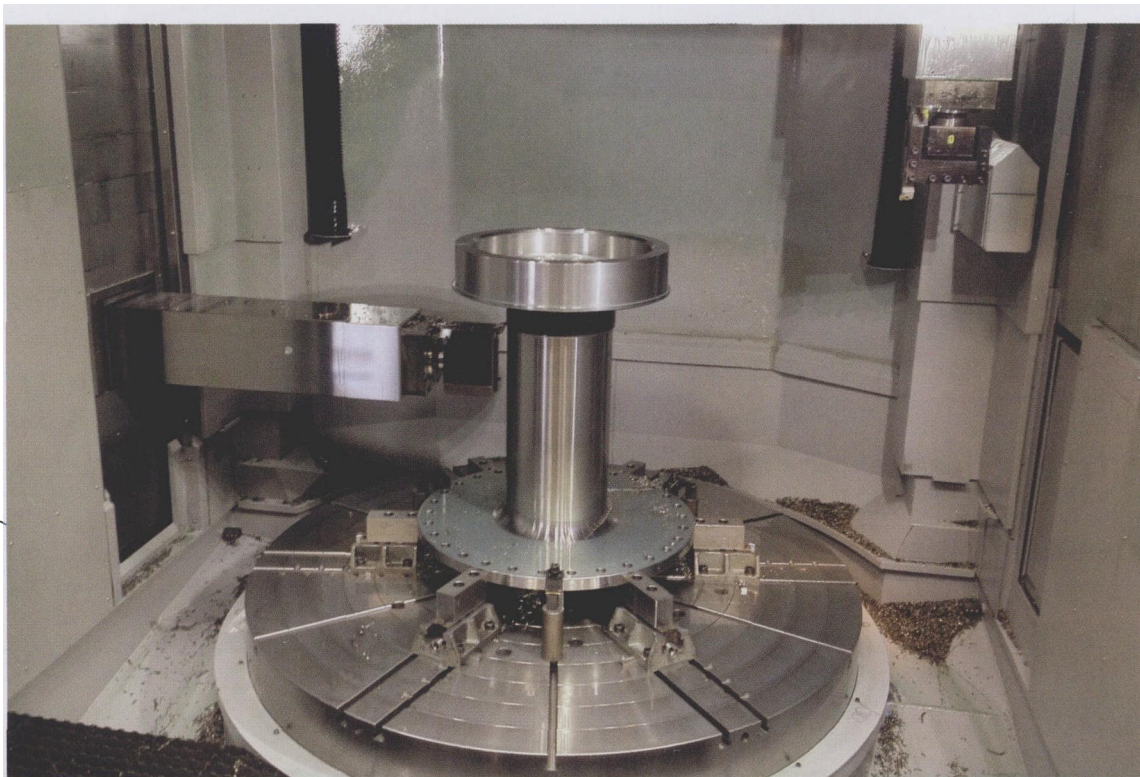
图1 这台 VTL 上的卧式滑枕能够到达这个高度约为 40 in 的工件两端宽凸缘之间的表面
