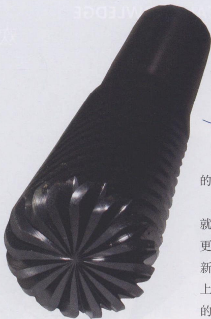
图2 刃数更多的刀具能够通过缩短加工周期节约能源。研究人员发现，16 刃的刀具具有最高的能效，但其成本也最为昂贵
