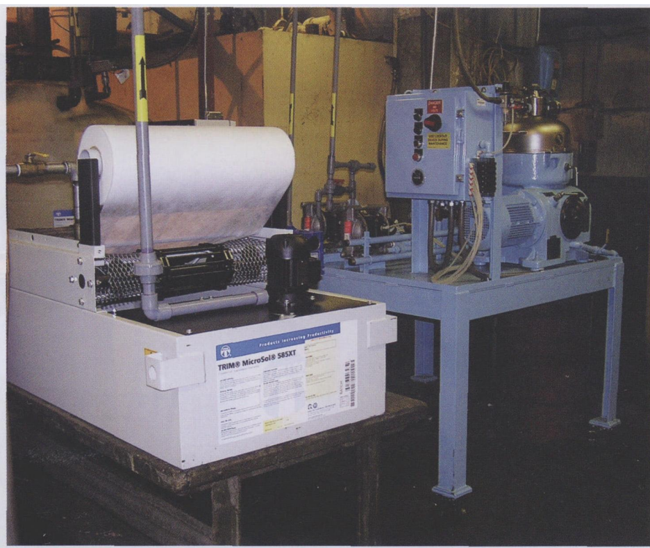
图 1 该冷却剂循环系统能够在满负荷生产时通过减少冷却剂和水的用量来降低生产成本
