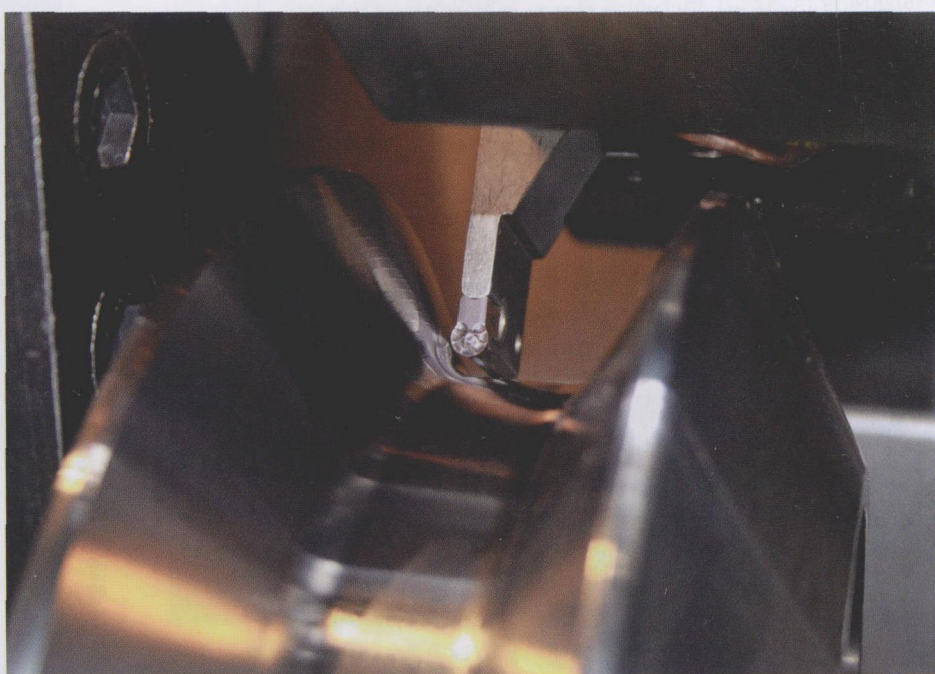
图 1 安装在一个长刀架上的带有 Y 型断屑器的 8 mm 宽的全半径冲车刀片
