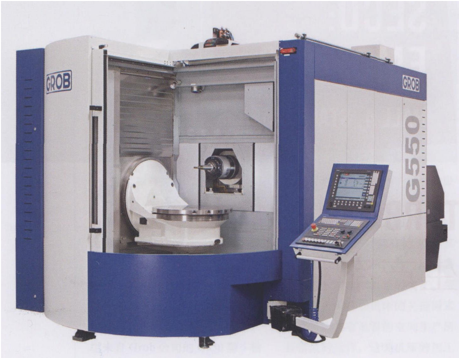
图 2 两个旋转轴都安装在机床的工作台之中，其中 A 轴的最大旋转度为 240°，B 轴可达 360° 全圆周旋转。结合其他的三个线性轴，可同时加工工件的五个面
