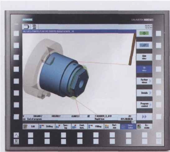
图 3 宝马公司汽车制造厂的操作人员表示，Grob 公司机床 CNC 系统上的 Sinumerik Operate 操作界面是非常直观的，因此使得新批次零件的调试设置要比以前更为容易
