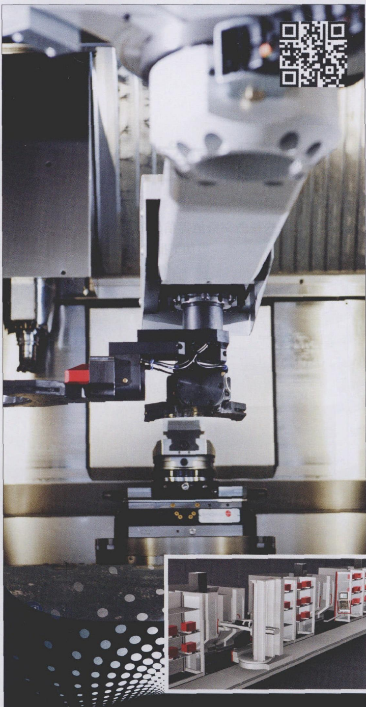
图2 长车削或短车削：两者都能通过 Traub TNL18 完成，并能实现迅速改装
