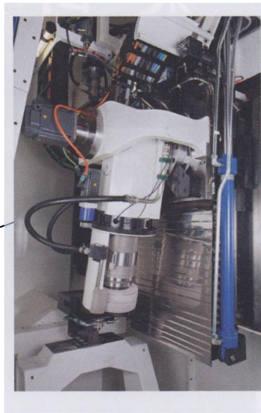
图 2 磨削系统 / 左动柱使用直线电机驱动液体静压滑台，配置直线电机、高分辨率编码器、闭环伺服系统
