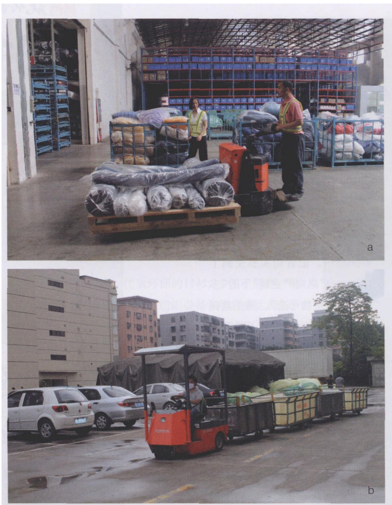
图3 BT 电动托盘车 LPE200 和丰田电动牵引车 CBT6 的导入,大幅提升了作业效率并削减了人力成本
