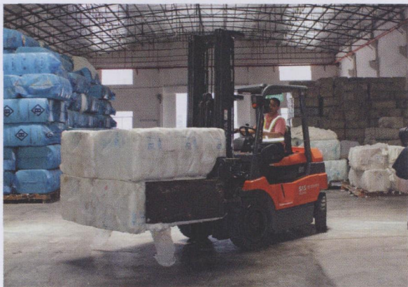
图2 搭载原装软包夹的丰田电动平衡重车 7FB
