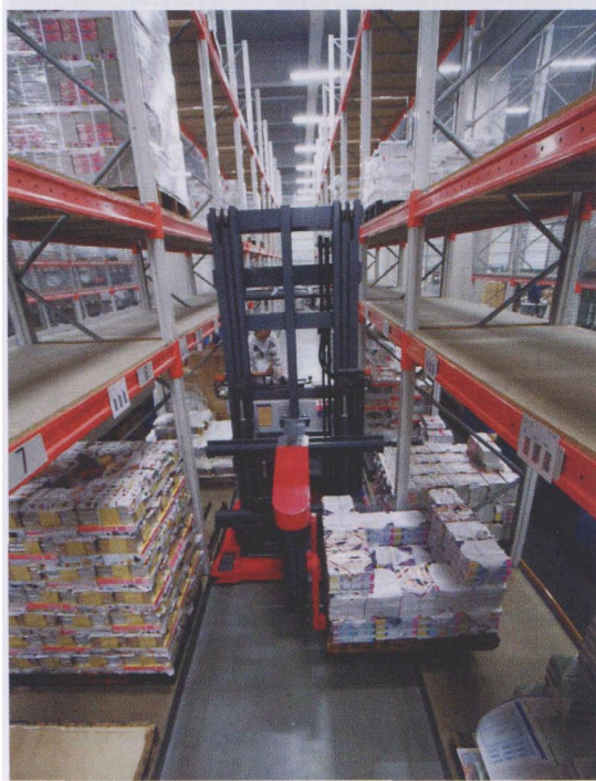
图4 中心采用三用途叉式升降机向重型货架补货
