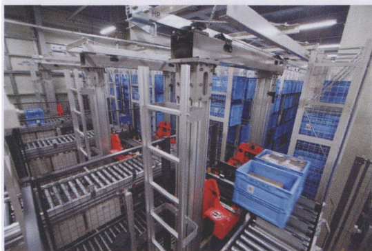
图2 箱盒式自动仓库内共设有5台升降机, 9888个箱盒容纳空间, 能够自动向箱盒式电子标签拣选系统补货
