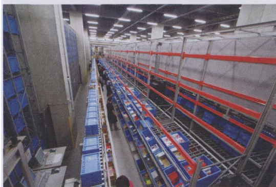
图3 户田中心内共有两条箱盒式电子标签拣选线。滚轮式货架(58个通道口, 870个液晶显示器)背后都设有专用的自动补货系统(一条通道, 两台推垛机)
