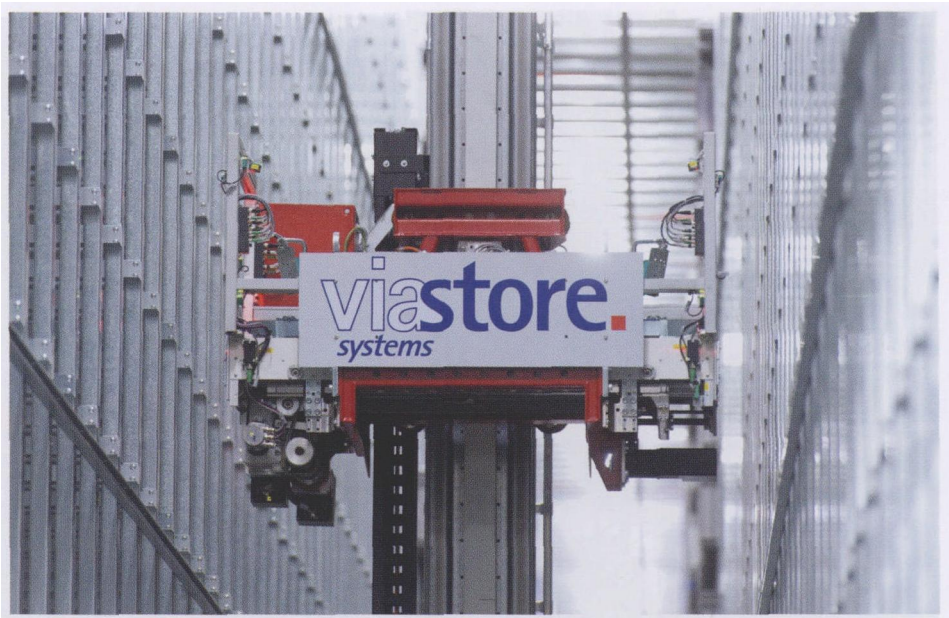
图 4 新一代 Viaspeed 自动化立体库实现了市场上最快的 6 m/s 的运转速度
