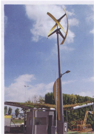
图 2 UGE 用螺旋形叶片对 Darrieus 设计类型进行修改以优化风能捕获、效率和美观性。该图为 1 kW 的 eddyGT 风力发电机, 它可以为环境服务公司 CESPA SA 园区的电动汽车充电站提供能源
