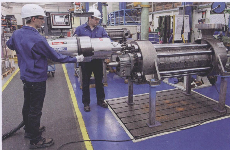
图4 电子控制的四轴拧紧机利用8个环形配置的Superbolt拧紧机头拧紧工业泵端面的螺栓
