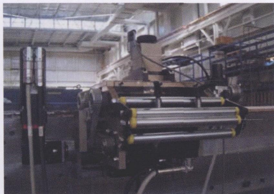
图2 这是由 Linear MOTIONEERING 生成的 AccuSlide 2HB 模型。2HB 是由一种由方形滑轨、滑台和集成滚珠丝杆组件构成的连续支承系统。Minster Machine 公司将它应用于要求高刚度的连续支承应用
