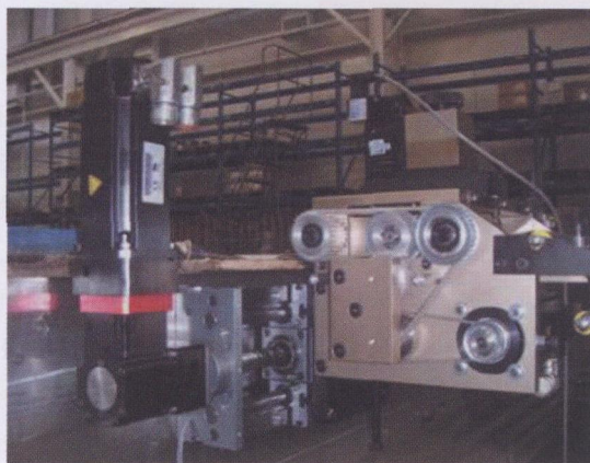
图 1 Minster Machine 公司使用 Thomson 网页选型工具 Linear MOTIONEERING 来设计 Z 型辊给料机的直线运动系统。通过这种方法, 他们将设计客户定制直线运动系统的时间从 3 h 缩短至 30 min
