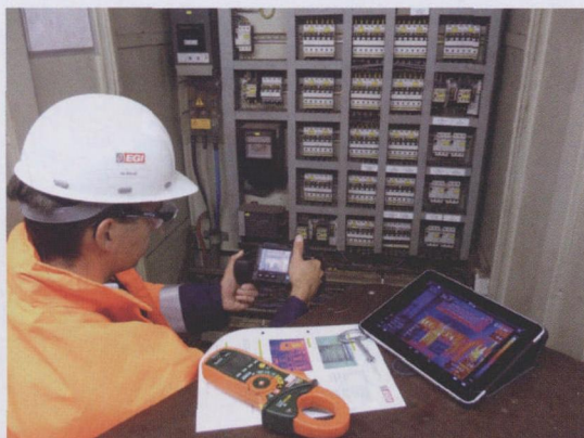
图 2 Michael Weight 执行热成像操作：通过蓝牙将 Extech 钳形表获得的数据传输到热像仪中。FLIR T440 通过无线 LAN 将热图像传输到个人平板电脑上
