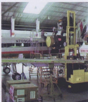
图 1 Hubtex 设备制造公司研制的专用设备在航空工业厂家使用的情况
