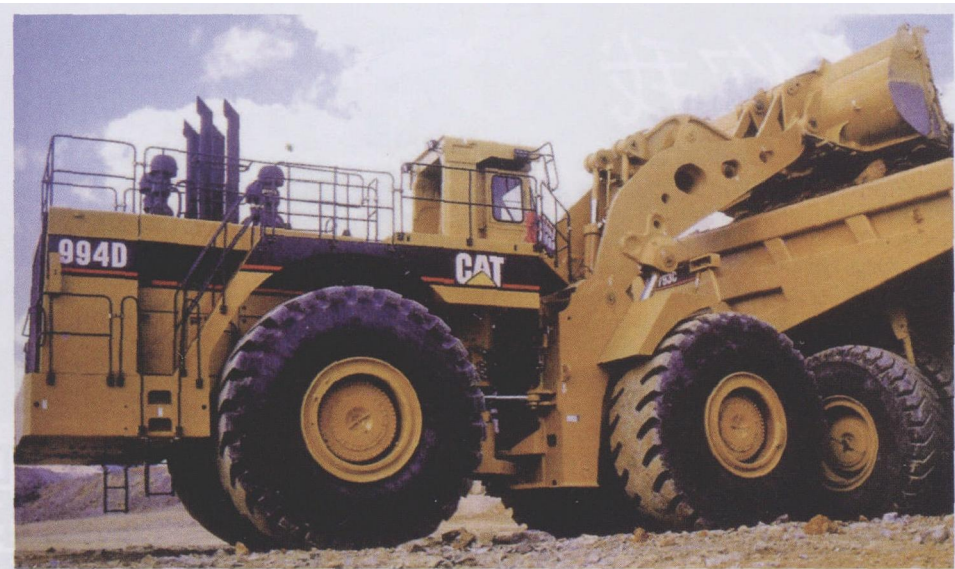
图 1 CAT 994D 挖掘机：发动机功率 1027 kW，工作重量 191200 kg。有效承载（标准的）31 m 3 ，总长 16948 mm，总高 5449 mm
