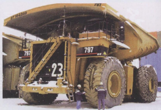
图3 长15 m、宽9 m、高7 m，重量600 t，轮胎重量5 t
