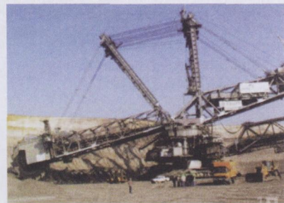
图4 228 挖掘机：重12804 t，长246 m，高106 m，宽46 m
