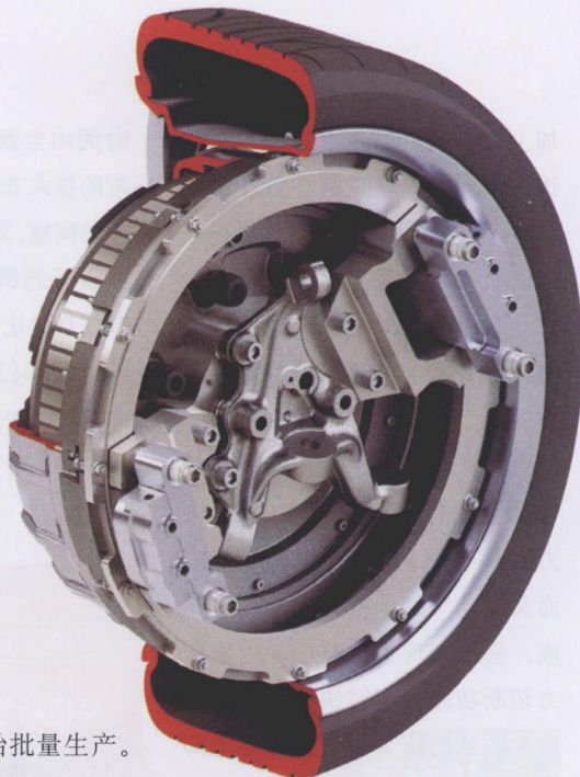
图1 从2005年开始，Protean Electric公司就开始生产轮毂电动机，并开发出了一系列的样品——从Mini Cooper、Brabus Mercedes到Vauxhall Transporter
