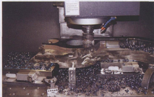
图 5 当要求用两个磁性卡盘装卡固定一个元件进行加工时，使用底板锁紧系统，将一个磁性卡盘安装在一个固定的位置上，同时，用手工方式使另一个磁性卡盘定位在元件下。凡是需要 3 个卡盘装卡固定的零件，先将两个卡盘锁定到已知的位置上，同时用手工方式使第三个卡盘定位
