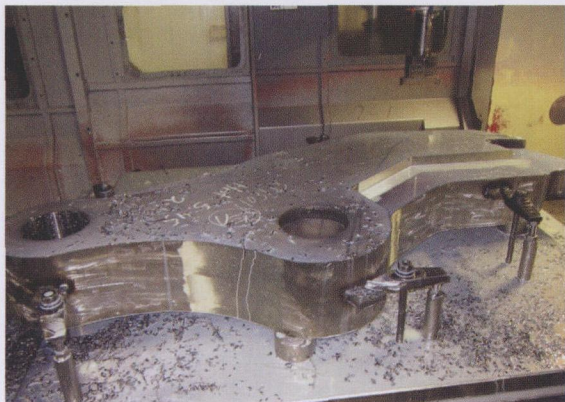
图2 以前, Genesis 公司在大型剪切机的组件上创建和焊接钢铁标牌, 如图中所示的层压板, 并使用传统的夹具来夹紧, 然后进行机加工操作
