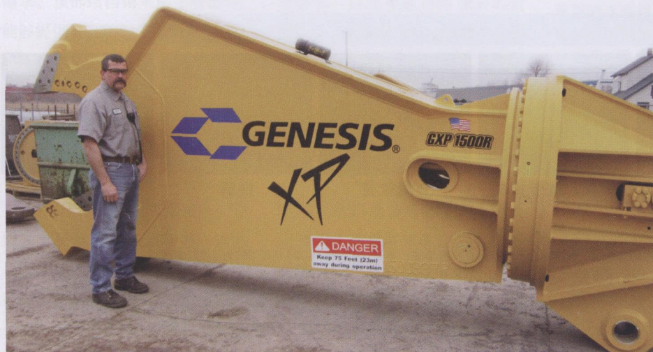
图 1 Woerle 先生说，采用一种公司范围内的精益生产管理思路，Genesis 公司就能够确定并解决瓶颈问题，加速挖掘机附件的生产，如这台用于拆迁、废料处理和材料搬运行业的大型剪切机
