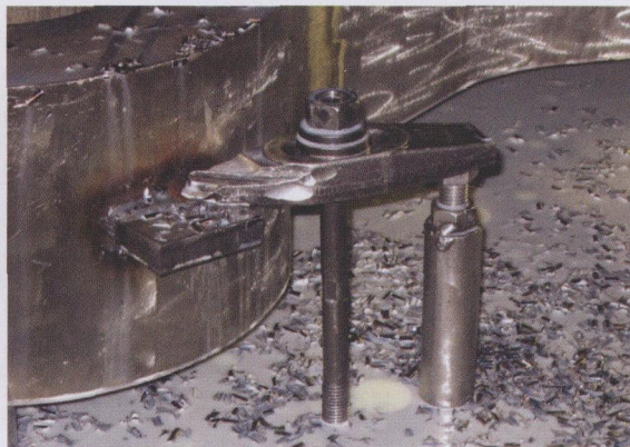
图3 需要进行的二次加工, 包括切除标牌并以手工方式打磨焊接区域。采用磁性卡盘来夹紧工件, 就不再需要这些毫无增值意义的加工步骤
