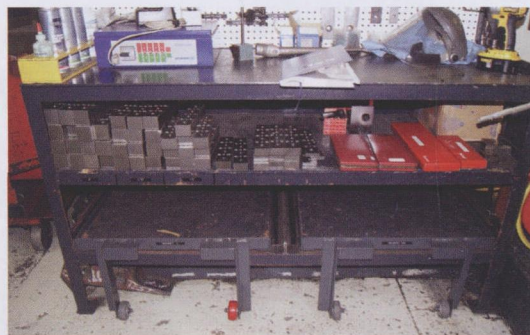
图 6 位于机床附近的工作站储存各种垫块，用于补偿各种不同零件的厚度，而电子控制单元则用于为电磁卡盘充电。车间内还备有手推车，用于储存磁性卡盘，并将它们运送到各机床上使用
