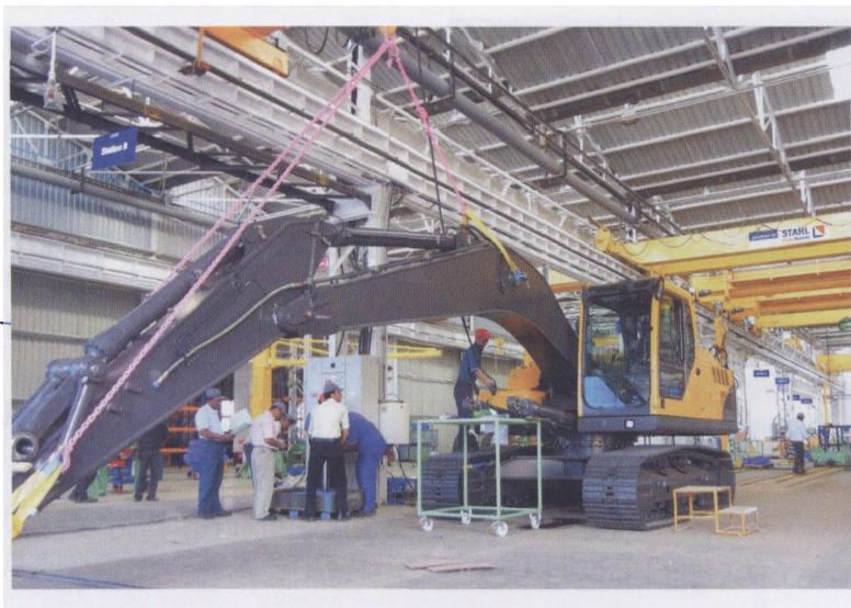
在这里有平行的半门式起重机、桥式起重机和壁行式起重机
