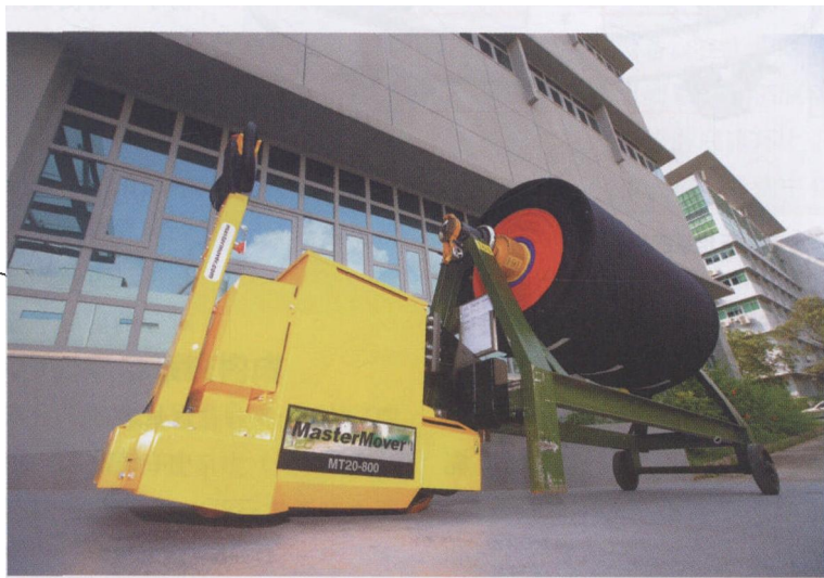
图 1 戈尔使用 Master Tug 系列中的 MT10/560 与 MT20/800 用于原料搬运和成品运输
