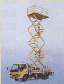
车载式高空作业台
