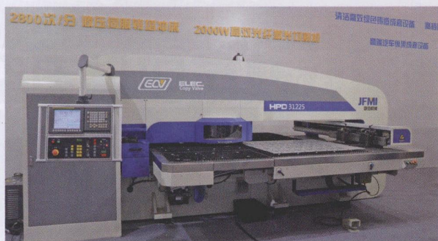
图2 在北京 CIMT 机床展中济南铸造厂展示的 HPD 31225 型板材加工设备就是全球首台采用 HDM 液压驱动系统的中等厚度板材加工设备
