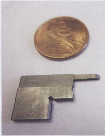
图 4 这种模具镶件是 Wire Specialists 公司典型的加工部件。在这个部件角部可以观察到小槽口的直径测量值为 0.003 in，而且要求加工成圆角
