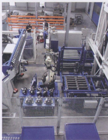
图2 Lidu 公司设置的 Auto-Cell 24/7 车削加工单元的两台 DMG 车床
