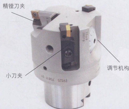
图 1 半精镗和精镗复合刀具
