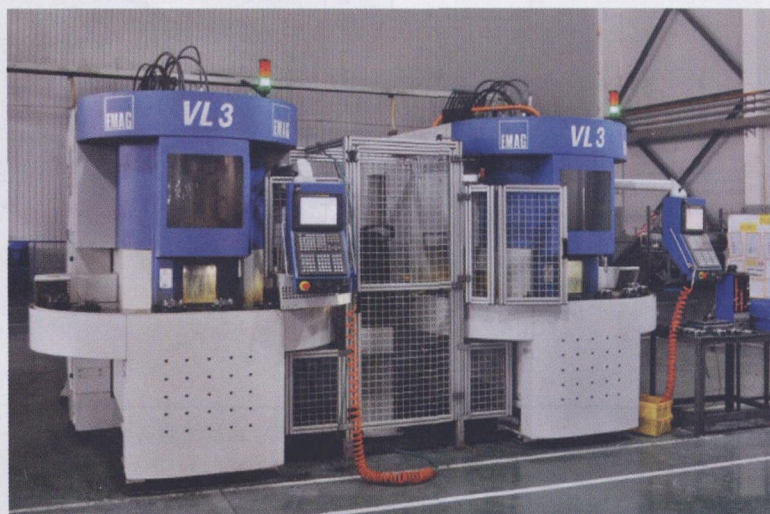
图 1 两台 VL 3 机床配一个翻转机械手作为一个生产单元
