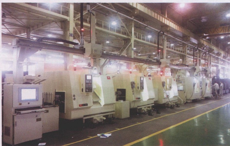
图 1 直角坐标机械手型机床上下料生产线
