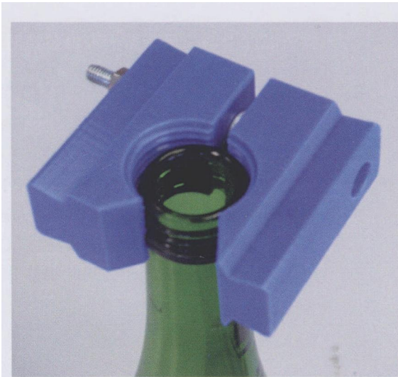
图 3 瓶子夹持器的两个夹块具有耐磨性，具有抑制微生物滋生的塑料材料来制造
