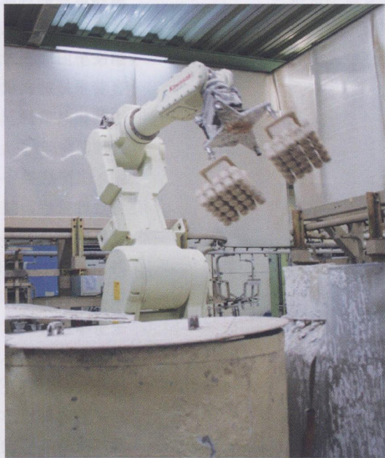
图 1 脱蜡铸造工艺：为机器人制模
