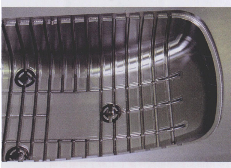
图 3 无需精车的窄花键，因为 Power Mini Shrink Chucks 刀柄拥有足够的刀具夹持力
