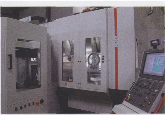
图 2 Langer 公司所采用的 Hermle BAZ C 42 U 型现代化加工中心通过配套的 Haimer 系统实现精确和可靠的加工
