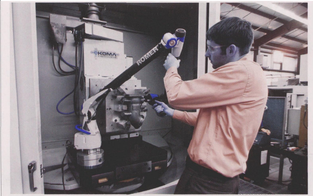
采用 Romer Absolute 测量臂，质量控制部门的技术员 Jeremy Hujet 先生可在该公司牧野 a82 型五轴机床的工作区内检测这个零件
