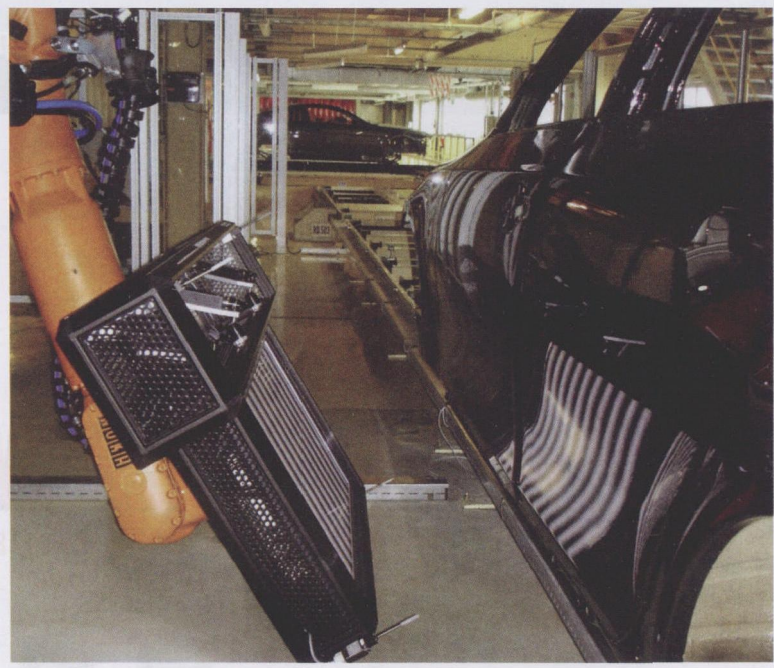
图 1 使用奥地利 Convergent 信息技术公司（CIT）提供的软件工具 Automappps，用来监管汽车车身 100% 喷漆表面的喷漆缺陷的应用实例
